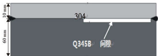
图 1 加热试验坯示意图 Fig. 1 Schematic diagram of heat test slab
